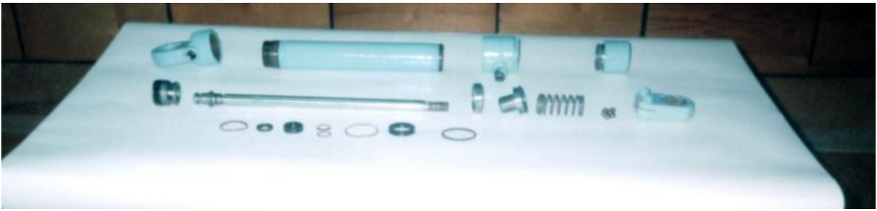
Рисунок 3.20 – Модель силового гидроцилиндра в разборном виде
