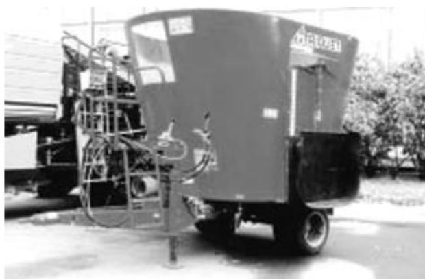
Рис. 22. Смеситель-кормораздатчик Trioliet серии Solomix.
