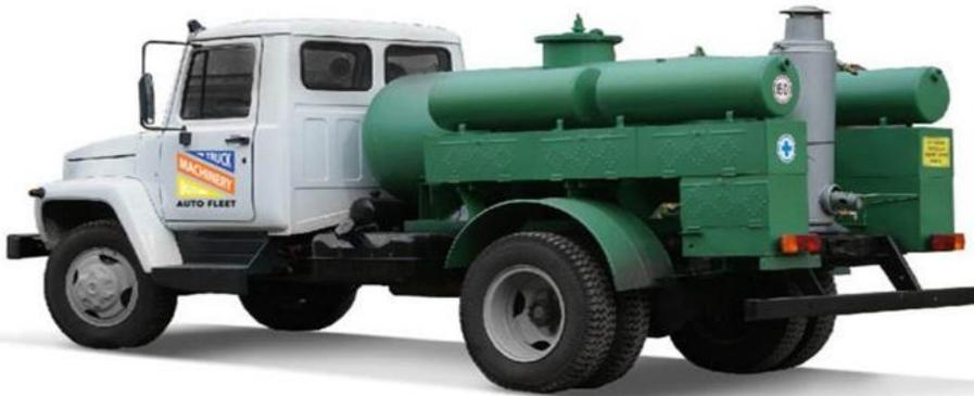
Дезинфекционная установка ДУК-1-01 на базе шасси ГАЗ 3309 "ГАЗОН 4х2"
