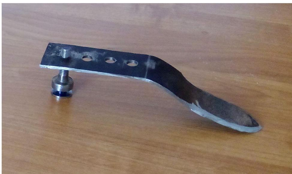
Рисунок 2.35 – Нож почвофрезы для подрезания сорняков
