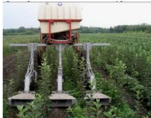
Рисунок 1.17 - Опрыскиватель и гербицидник
