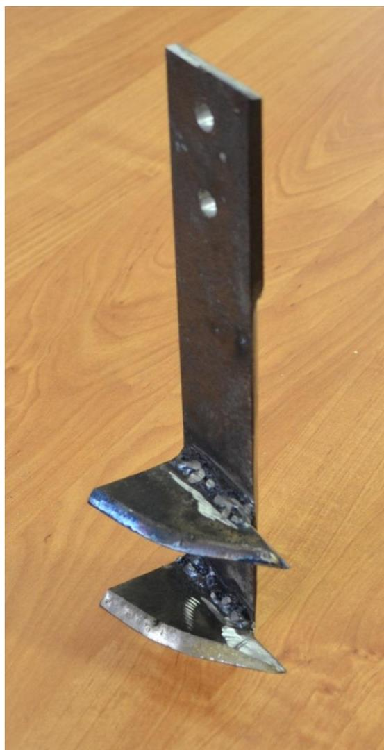
Рисунок 2.41 – Конструкция рабочего активного органа для основной обработки почвы
