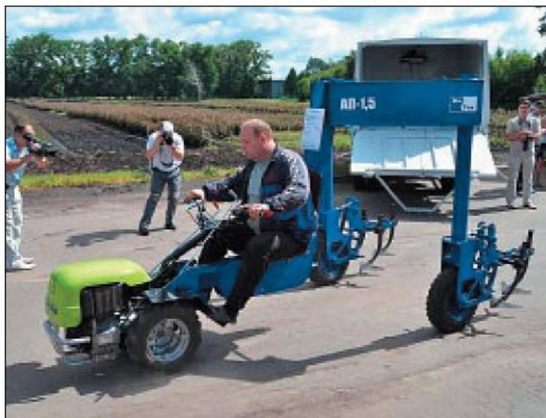
Рисунок 1.21 – Адаптер АП-1,5 с моторблоком для работ в питомниках
