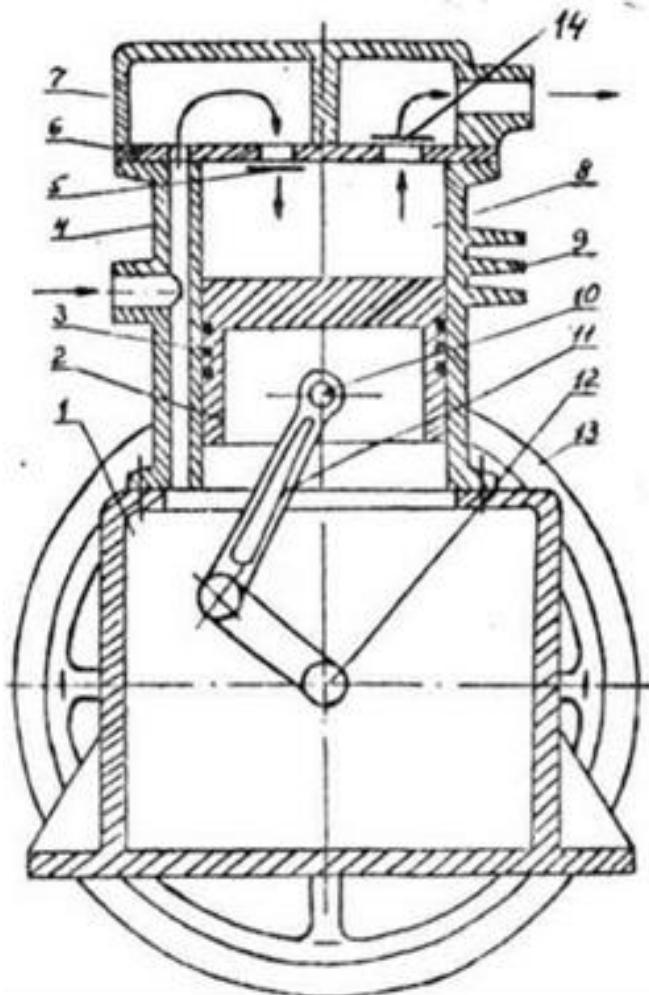
Рис. 20. Схема хладонового непрямоточного сальникового компрессора.
