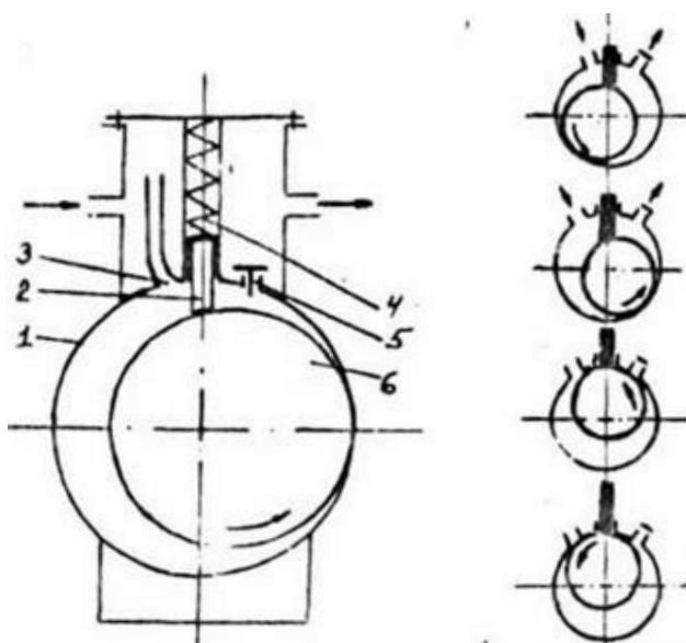
Рис. 21. Схема ротационного компрессора
