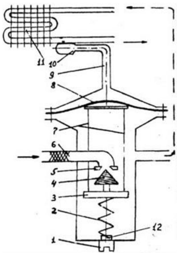
Рис. 22. Схема терморегулирующего вентиля.
