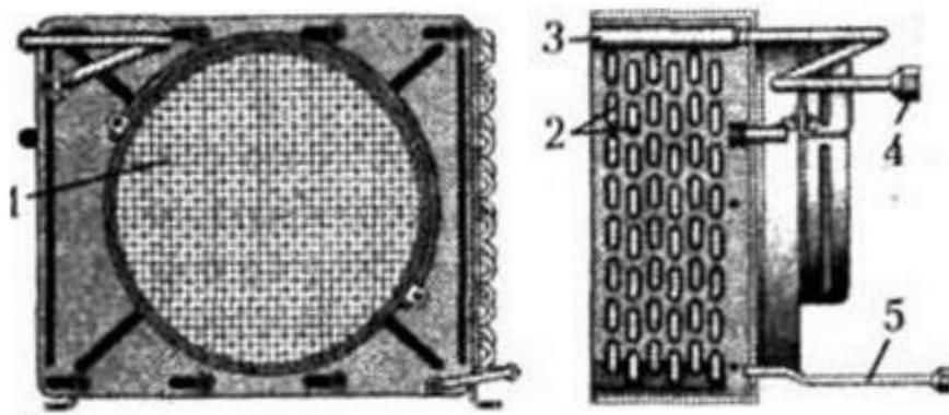
Рис. 6. Конденсатор 4Ф-12 (без вентилятора)
