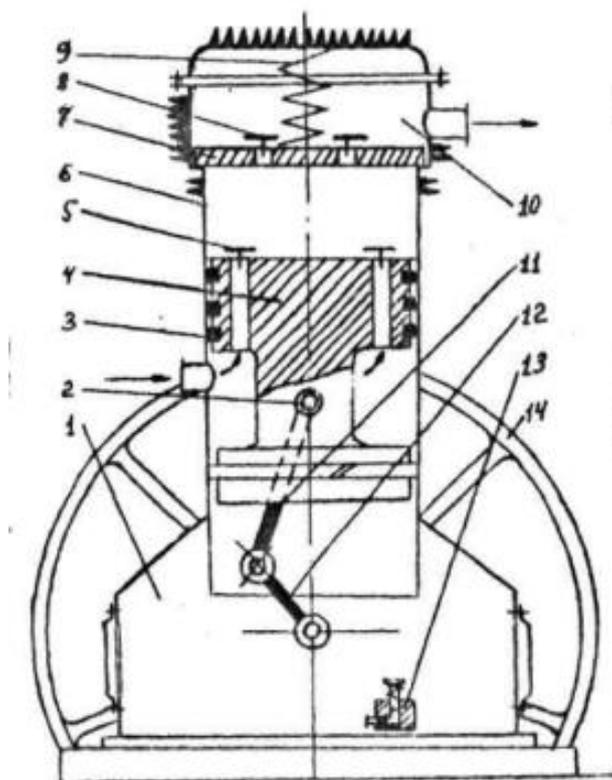
Рис. 17. Схема аммиачного прямоточного компрессора
