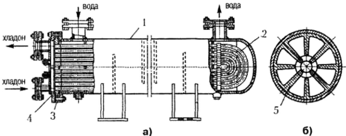
Рис. 14. Кожухозмеевиковый испаритель: а) общий вид, б) поперечный разрез трубы
