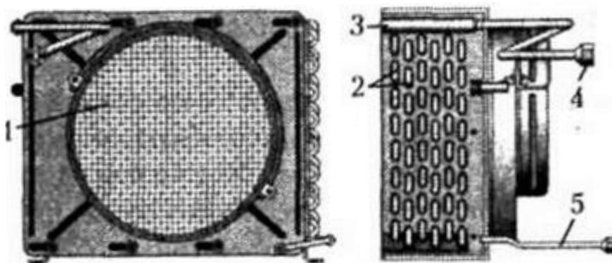
Рис. 6. Конденсатор 4Ф-12 (без вентилятора)
