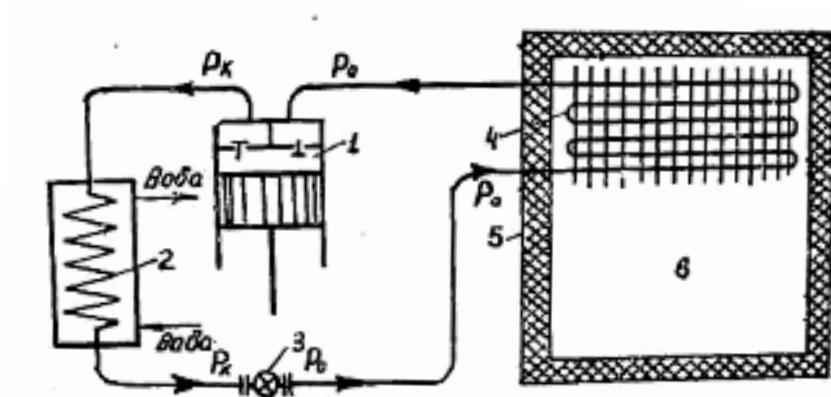
Рис. 1. Паровая компрессионная холодильная машина
