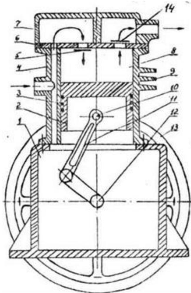
Рис. 20. Схема хладонового непрямоточного сальникового компрессора.
