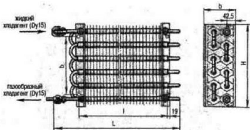
Рис. 7. Испаритель ИРСН (испаритель ребристый сухой настенный)
