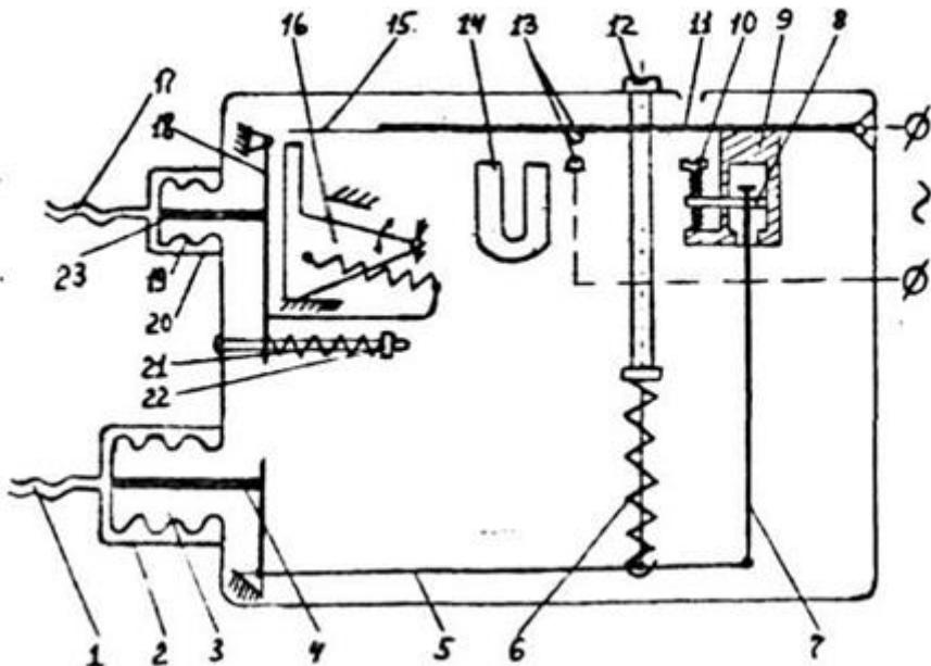
Рис. 23. Схема реле давления РД - 1.
