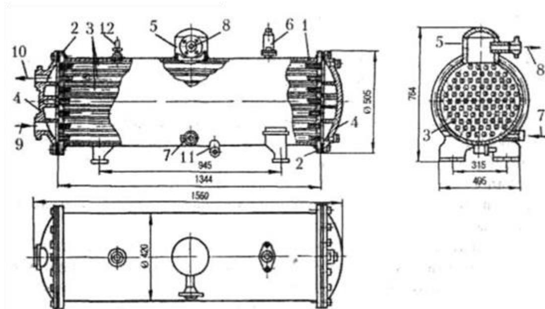
Рис. 13. Аммиачный кожухотрубный испаритель ИП -12
