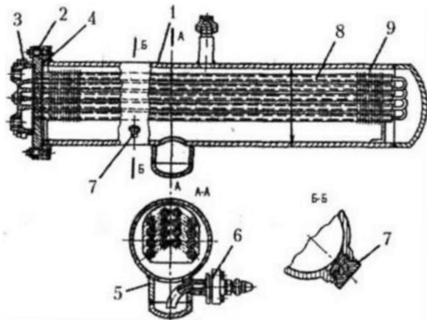
Рис. 11. Кожухо-змеевиковый конденсатор КТР-3
