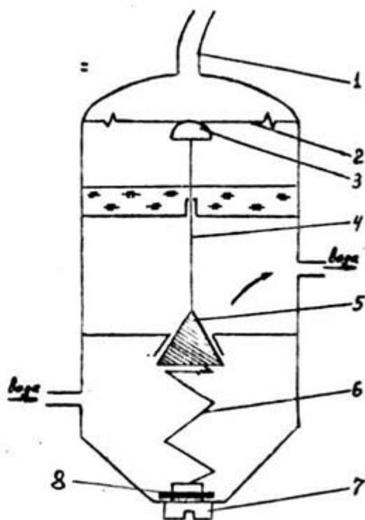
Рис. 24. Схема водорегулирующего вентиля
