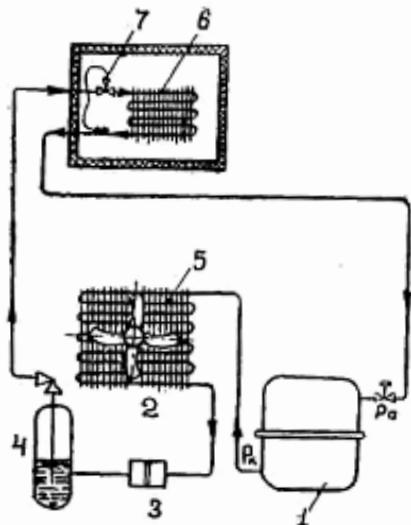
Рис. 3 Холодильная машина с агрегатом ВС 07~3
