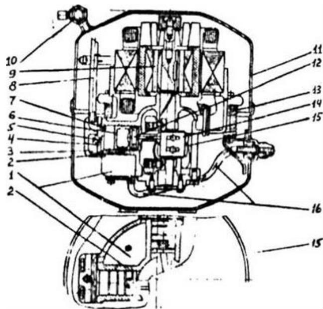
Рис. 18. Схема хладонового герметичного компрессора.
