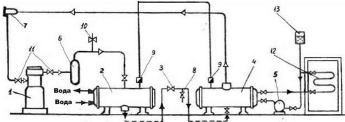
Рис. 10. Схема рассольной системы охлаждения холодильных камер
