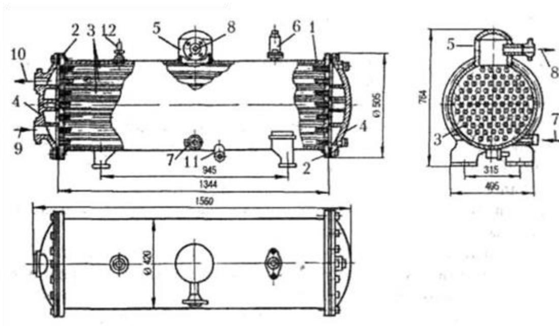
Рис. 13. Аммиачный кожухотрубный испаритель ИП -12
