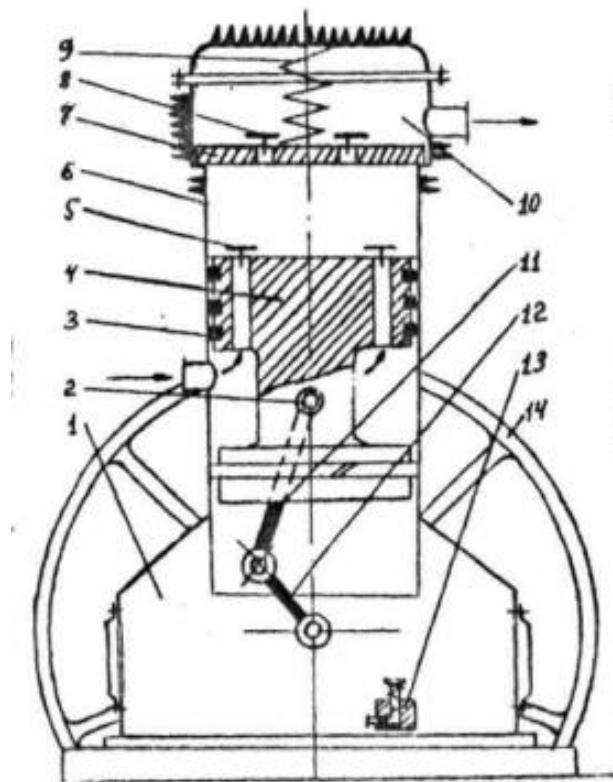
Рис. 17. Схема аммиачного прямоточного компрессора
