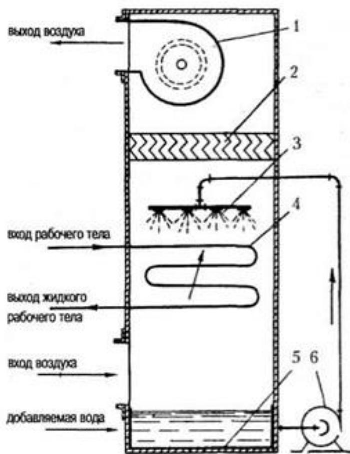
Рис. 12. Схема испарительного конденсатора
