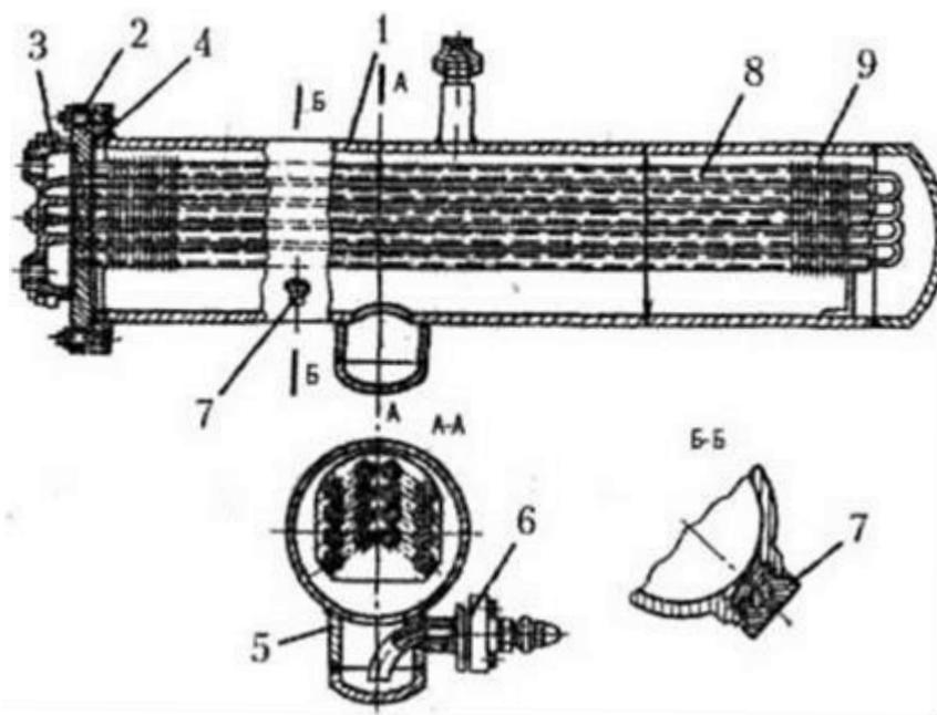
Рис. 11. Кожухо-змеевиковый конденсатор КТР-3
