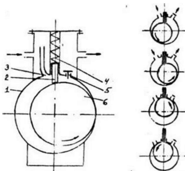
Рис. 21. Схема ротационного компрессора
