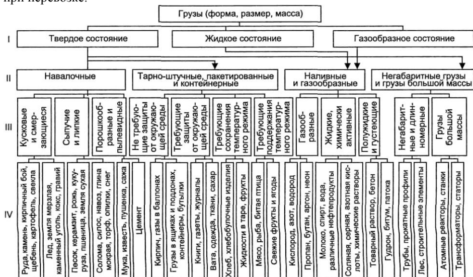
Рис. 1. Классификация грузов по физико-химическим свойствам: I - по физическому состоянию; II - по приспособленности к выполнению погрузоч-
