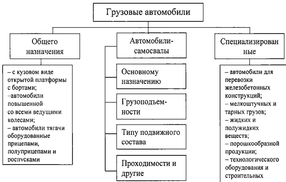
Рис. 2. Классификация грузовых автомобилей
