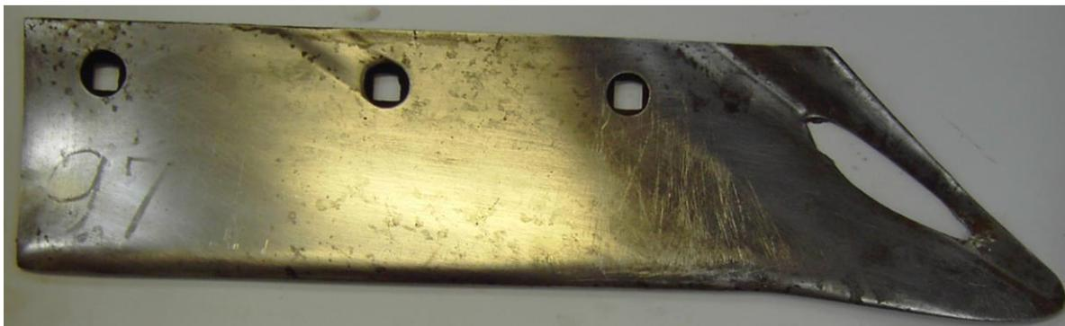
Рисунок 25 – Лучевидный износ носка лемеха, осложненный сквозным протиранием
