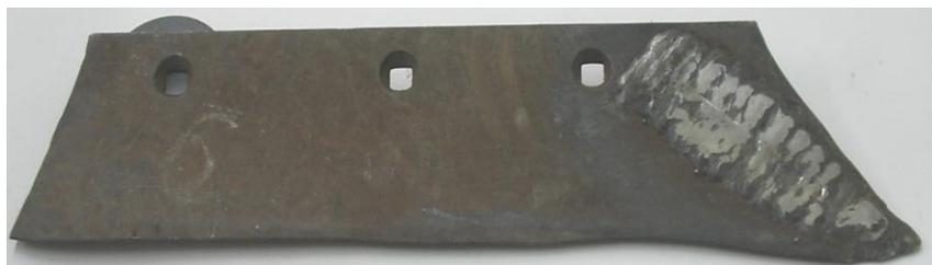
Рисунок 31 – Наплавка второго слоя электродом Т-590
