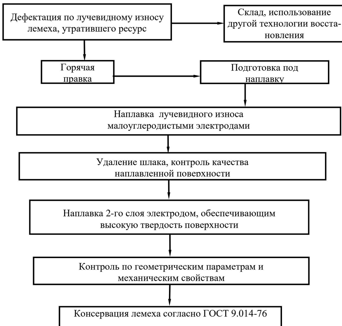
Рисунок 28 – Схема общего технологического процесса восстановления лемеха
