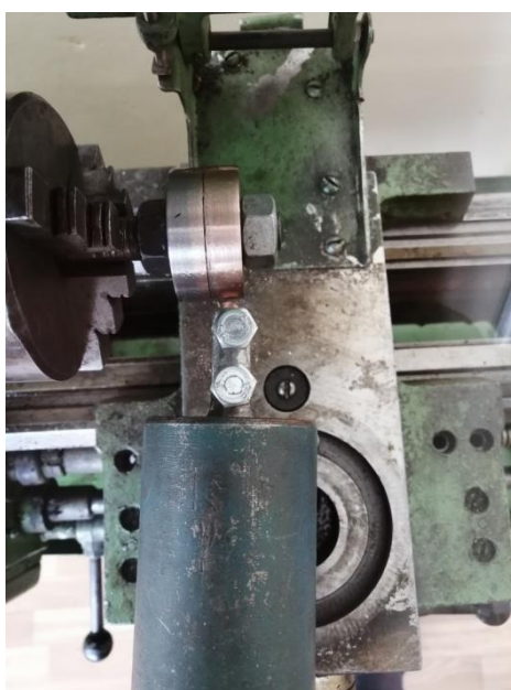
Рисунок 3 – Получение медного подслоя на стали 45 в среде глицерина
