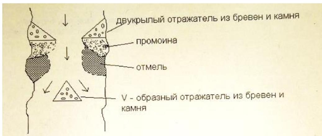
Запруды (подпорные сооружения) углубляют заводи, создают новые, улавливают тонкие наносы на притоках, подпирают уровень в водопропускных трубах для прохода рыбы, замедляют течение для осаждения органических остатков. Бывают в виде каменной наброски, бревен (широко распространены).
