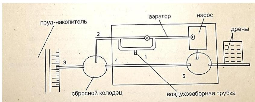
При работе насоса в аэраторе образуется вакуум и засасывается воздух
