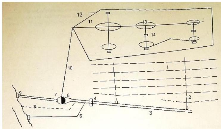
Летний и раннеосенний дренажный сток недостаточно разбавлен и его направляют в аванкамеру 5 и насосную станцию по трубопроводу 10 в трубы – разбрызгиватели 14, на малопродуктивные земли 11, которые переувлажняются, в том числе и из реки по трубе 8. Поверхностный сток с малопродуктивных земель 11 исключаются дамбой 12. В местных понижениях организуются пруды 13 с уплотненным дном для сбора вод местного стока. Так создается угодья для охотничьего хозяйства и улучшается ландшафт конкретного района.
