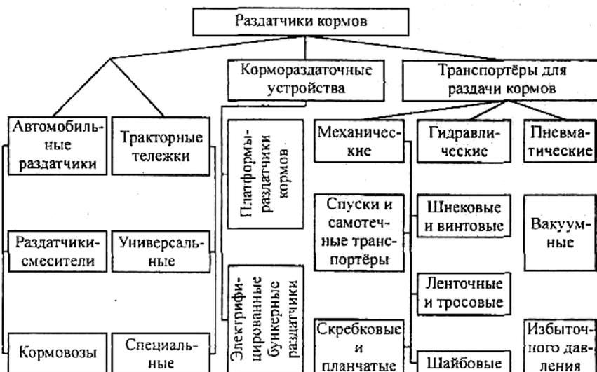
Рис. 23.1. Классификация раздатчиков кормов
