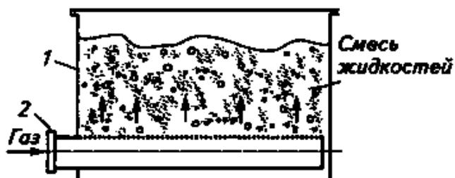
Рис. 7. Схема пневматического смесителя (барботера)
