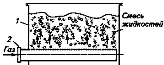
Рис. 7. Схема пневматического смесителя (барботера)
