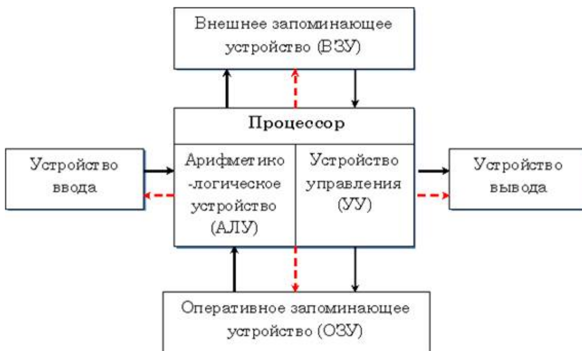
Рис. 2. Архитектура ЭВМ, построенная на принципах фон Неймана
