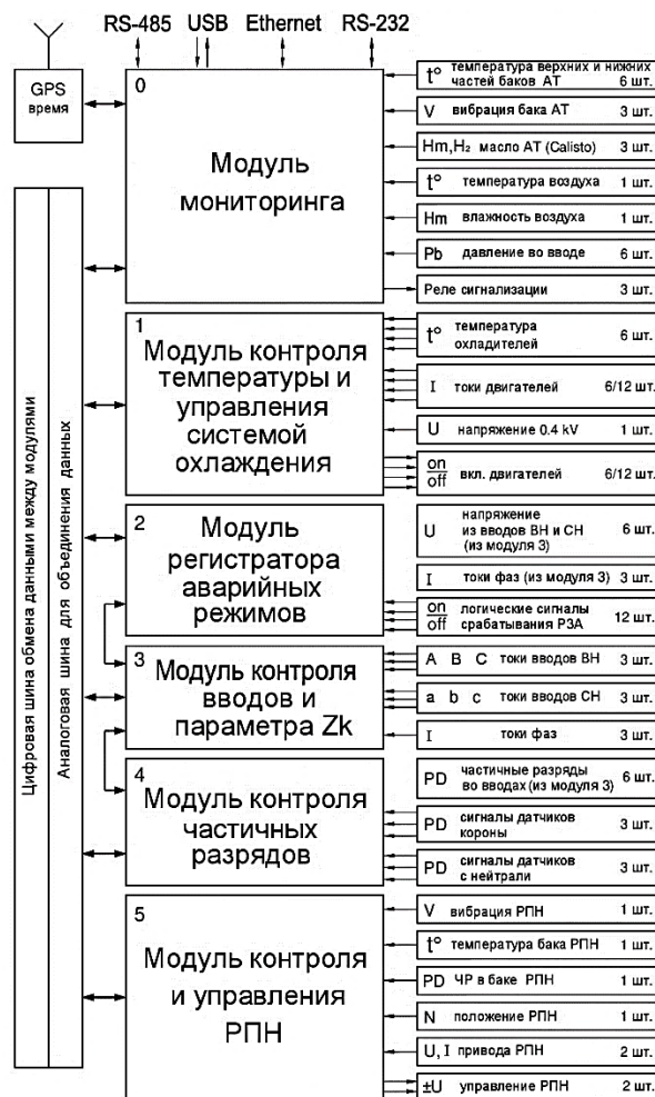
Рисунок 1 – блок-схема системы TDM для мониторинга группы АТ
