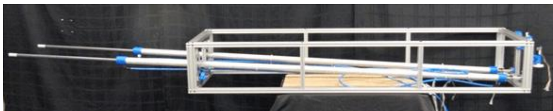
Рисунок 6 - Двухмеханизмная система с шестью камерами
