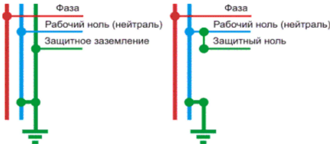
Рис. 26. Отличие защитного заземления и защитного "нуля"
