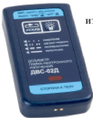
Рис. 28. Индивидуальный дозиметр гамма и нейтронного излучения ДВС-02Д
