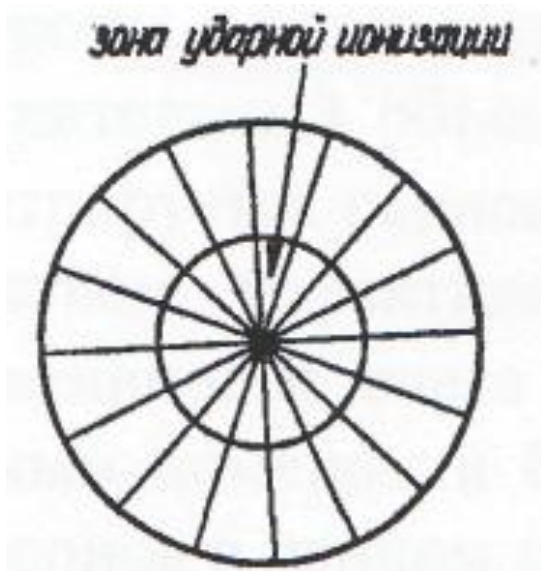
Рис. 4. Поперечное сечение счетной трубки с изображением расположения силовых линий
