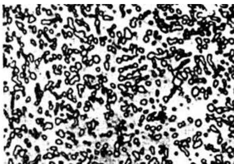
Рисунок 5 – Микроструктура эвтектоидной углеродистой стали после сфероидизирующего отжига. Зернистый перлит. x500
