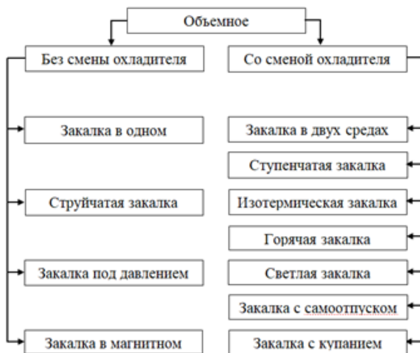
Рисунок 2 – Способы объёмной закалки в зависимости от условий охлаждения
