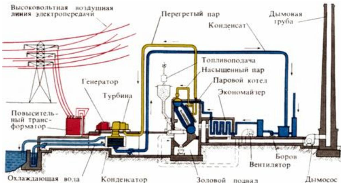
Рисунок 1.2 - Схема тепловой конденсационной электростанции
