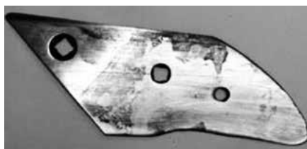
Рисунок 3 - Износ полевого обреза долот производства фирмы «Lemken»
