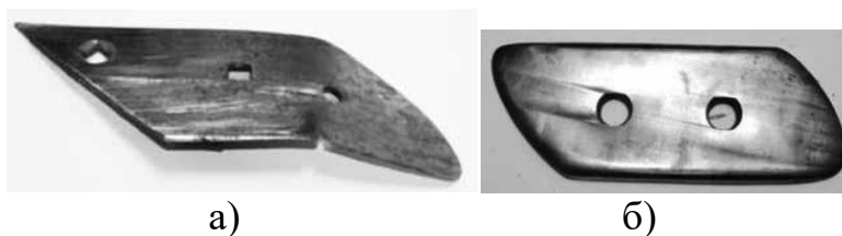
Рисунок 4 – Выбракованные долота составных лемехов европейских компаний: а – фирмы «Lemken», с недопустимо малой толщиной (изгиб долота); б – фирмы «Vogel & Noot», с полной утратой режущих частей и лучевидным износом
