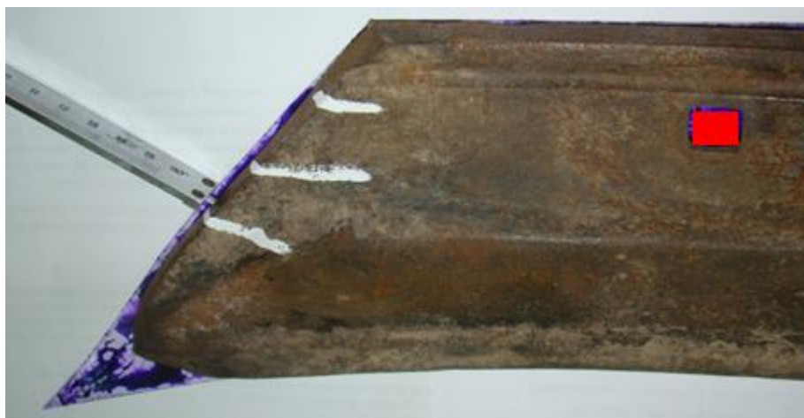
Рисунок 2 – Схема измерения износа полевого обреза лемеха
