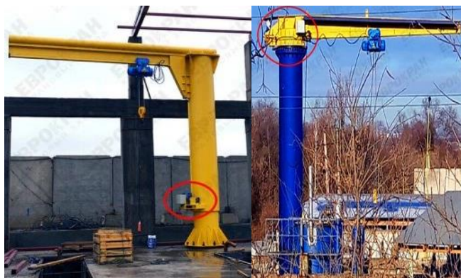
Рисунок 6 - Кран консольный стационарный электрический с механизмом поворота в нижней части крана и с механизмом поворота в верхней части крана
