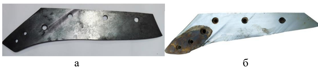
Рисунок 1 - Характерный износ режущее-лезвийной части импортных лемехов: а - лемех фирмы «Grégoire Besson»; б - лемех фирмы «Kuhn»
