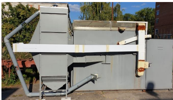
Рисунок 1 - Модульная сушилка аэродинамического нагрева с подсоединением сушильной шахты к циркуляционному каналу сушильной камеры
