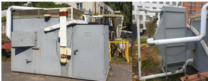
Рисунок 2 – Модульная сушилка аэродинамического нагрева с подсоединением сушильной шахты к камере ротора-нагревателя
