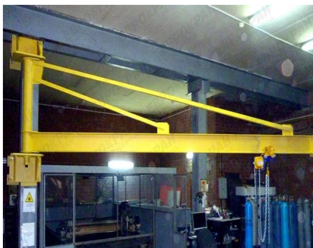
Рисунок 4 - Настенный консольный ручной кран
