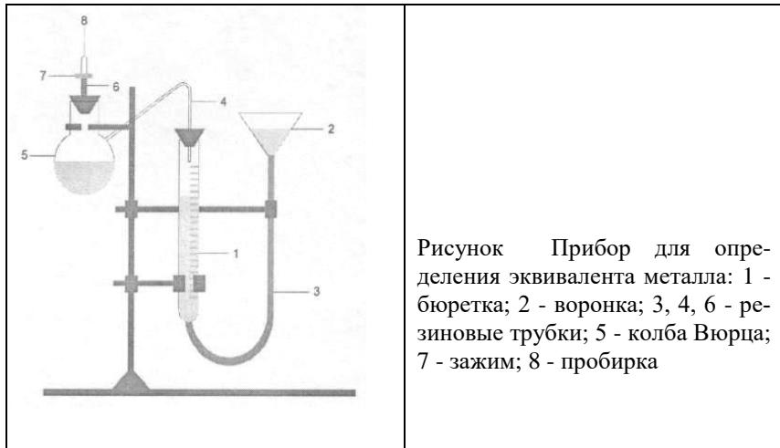
Рисунок Прибор для определения эквивалента металла: 1 - бюретка; 2 - воронка; 3, 4, 6 - резиновые трубки; 5 - колба Вюрца; 7 - зажим; 8 - пробирка
