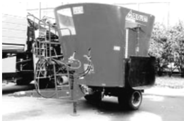
Рис. 17. Смеситель-кормораздатчик Trioliet серии Solomix.
