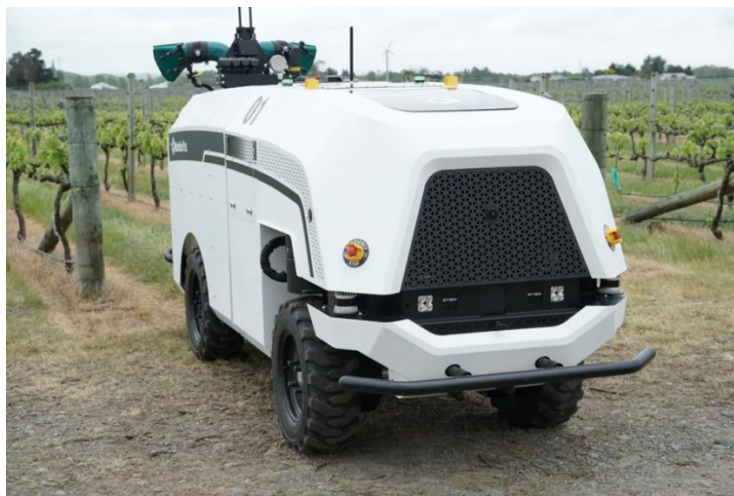
Рисунок 2 - Автономная модульная платформа для садов и виноградников (UGV)
