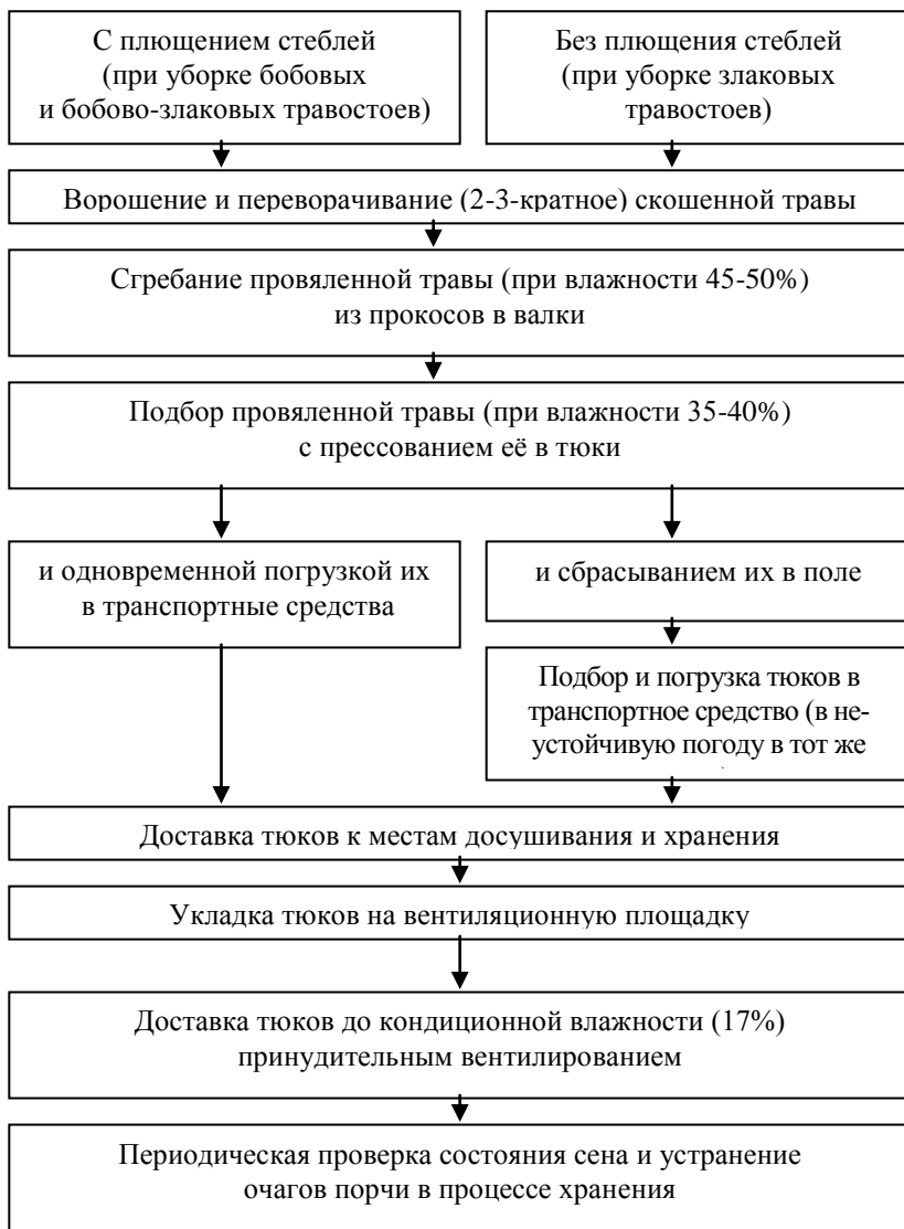
Рис. 4 Схема основных производственных операций заготовки сена с повышенной влажностью в рулонах с хранением в полимерном рукаве
