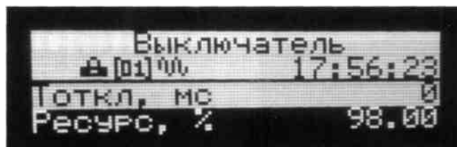
Рисунок 2. Ресурс выключателя на экране устройства БМРЗ
