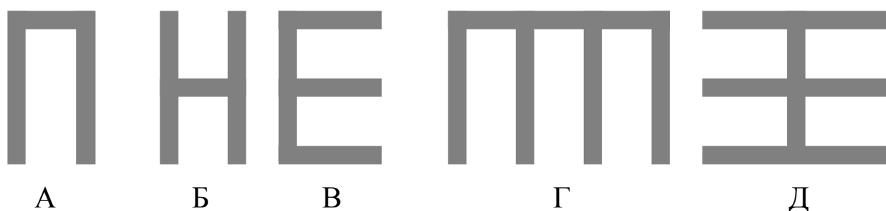
Рис. 4. Схемы конструкции хранилищ для консервирования плющеного зерна
