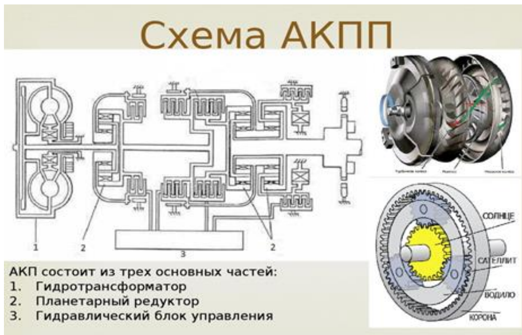
Рисунок 9 – Схема работы АКПП
