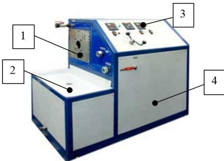
1 – место крепления проверяемого узла; 2 – масло сборник; 3 – панель управления стандом; 4 – корпус станда.
