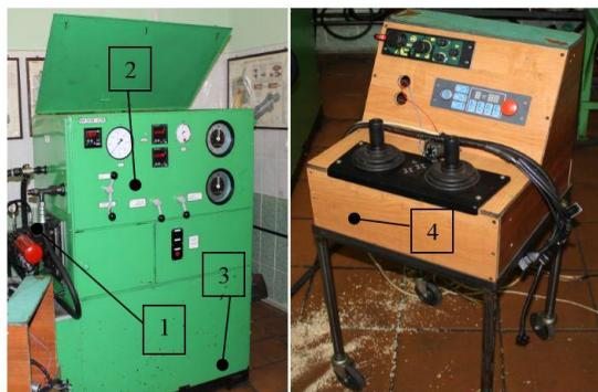
1 – место крепления проверяемого узла; 2 – панель управления стендом; 3 – корпус стенда; 4 – передвижная тележка с джойстиковым управлением.
