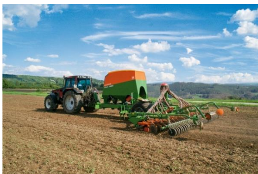
Рис. 27. Сеялка Amazone CITAN
