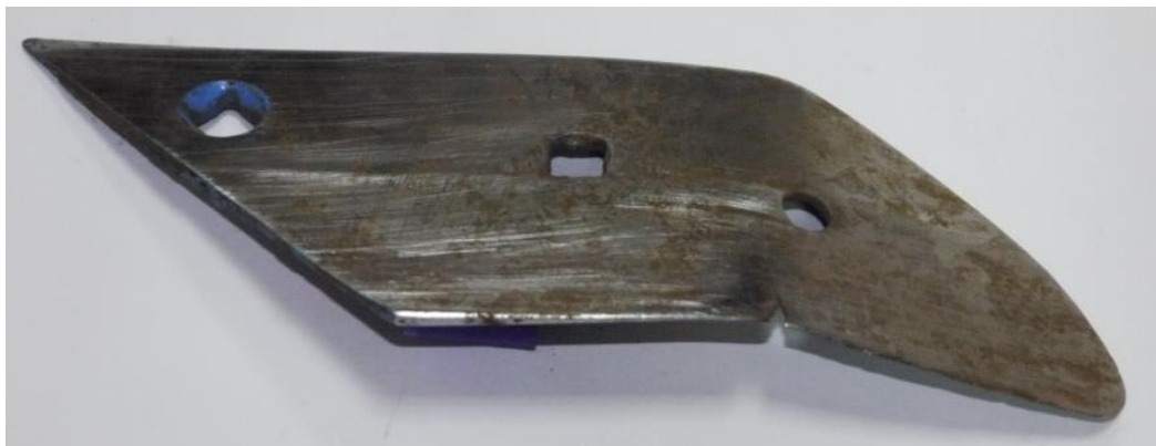
Рисунок 42 – Изношенное долото фирмы Lemken с недопустимо малой толщиной (изгиб долота)
