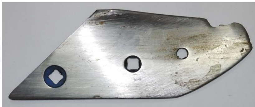
Рисунок 38 – Лучевидный износ долота фирмы Lemken
