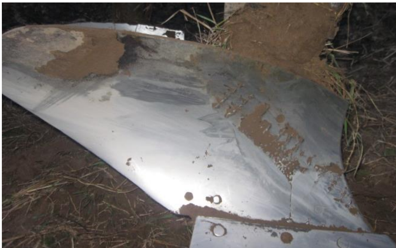
Рисунок 98 – Отвал после истирания наплавленной области
