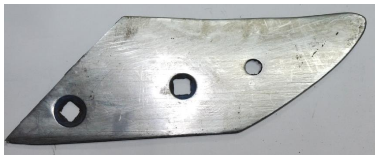
Рисунок 39 – Износ носка долота фирмы Lemken
