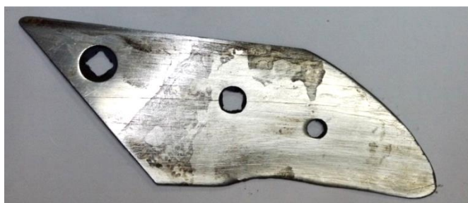
Рисунок 40 – Износ полевого обреза долот производства фирмы Lemken
