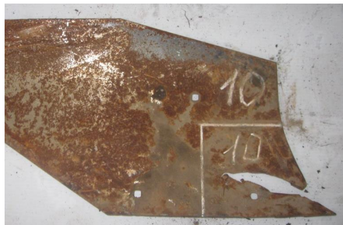
Рисунок 90 – Характерный износ отвала плужного корпуса
