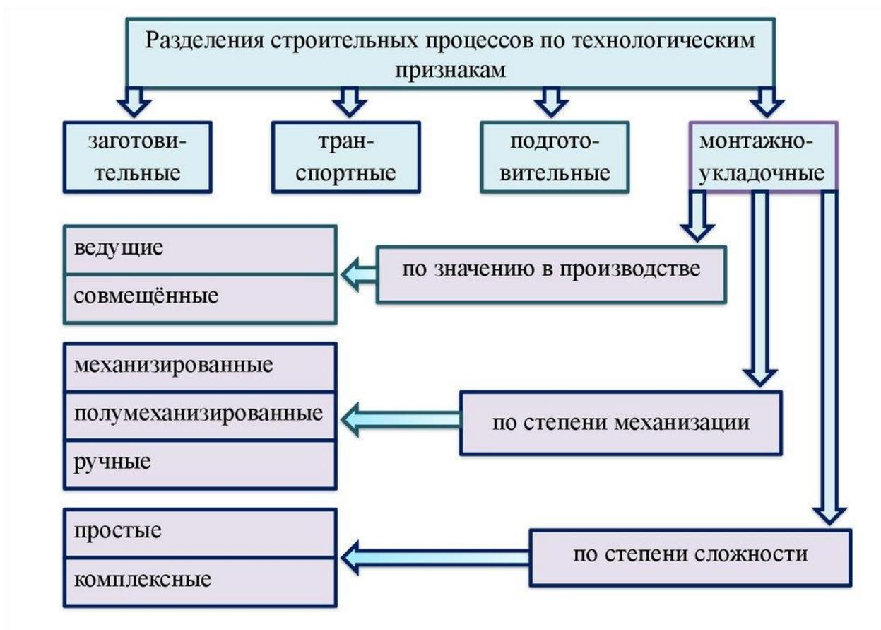
Рисунок 1.1 – Технологическая схема производственных процессов
