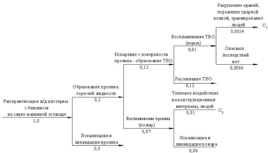
Рисунок 3.5 – «Дерево событий» при разгерметизации ж/д цистерны с бензином на сливно-наливной эстакаде
