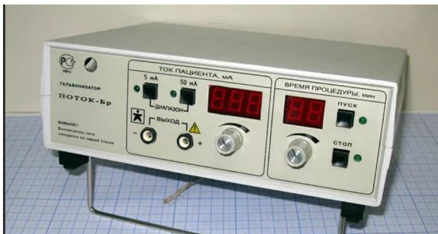
Рис. 10. ПОТОК-Бр – аппарат для гальванизации и лекарственного электрофореза
