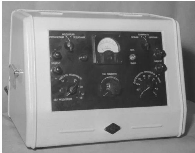
Рис. 11. Аппарат АСМ-2 - импульсный электронный генератор для электростимуляции мышц
