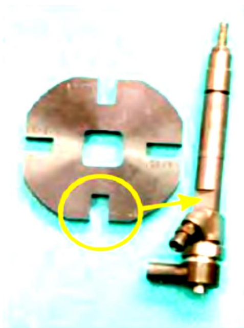
Рисунок 9 - Паз под корпус форсунки
