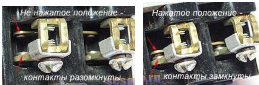
Рисунок 44 – Устройство и принцип действия кнопки «Пуск»
