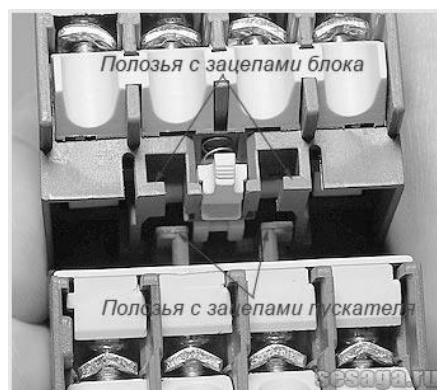
Рисунок 21 - Соединение блока контактов с контактной системой магнитного пускателя
