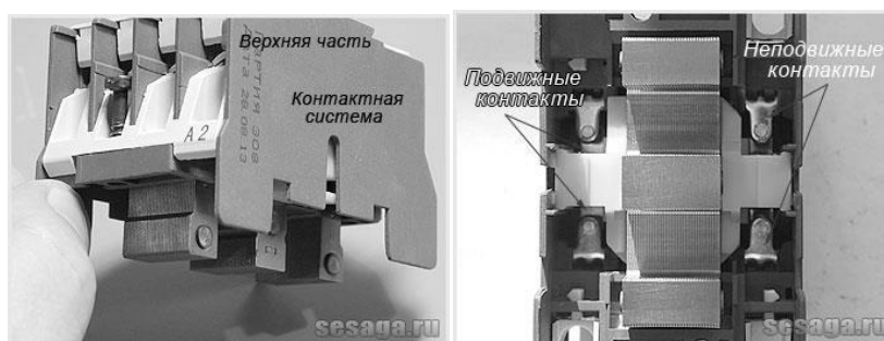
Рисунок 2 - Устройство верхней части магнитного пускателя
