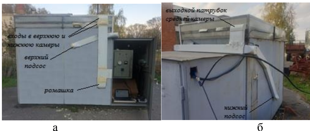
Рисунок 1 - Общий вид сушилки с комбинированным теплообменником (в режиме прямого вращения): а – со стороны верхнего подсоса; б – со стороны нижнего подсоса
