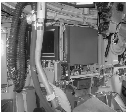
Рисунок 62 - Прибор химической разведки дистанционного действия ПХРД-2Б с машиной РХБ разведки.
