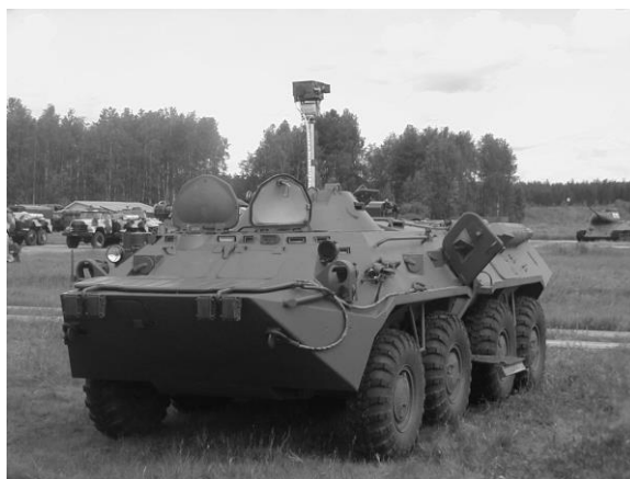
Рисунок 62 - Прибор химической разведки дистанционного действия ПХРД-2Б с машиной РХБ разведки.
