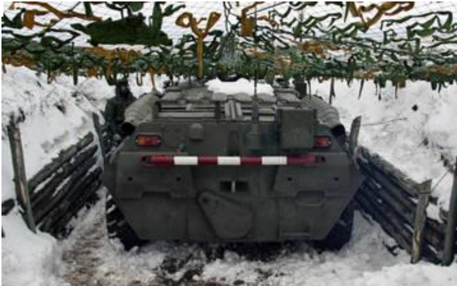
Рисунок 77 - Разведывательно-поисковая машина РПМ-2 находится в окопе и ведет РХБ разведку с развернутым прибором химической разведки дистанционного действия ПХРДД-2.
