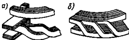
Рис. 1.1.25. Транспозиция в винтовых обмотках
